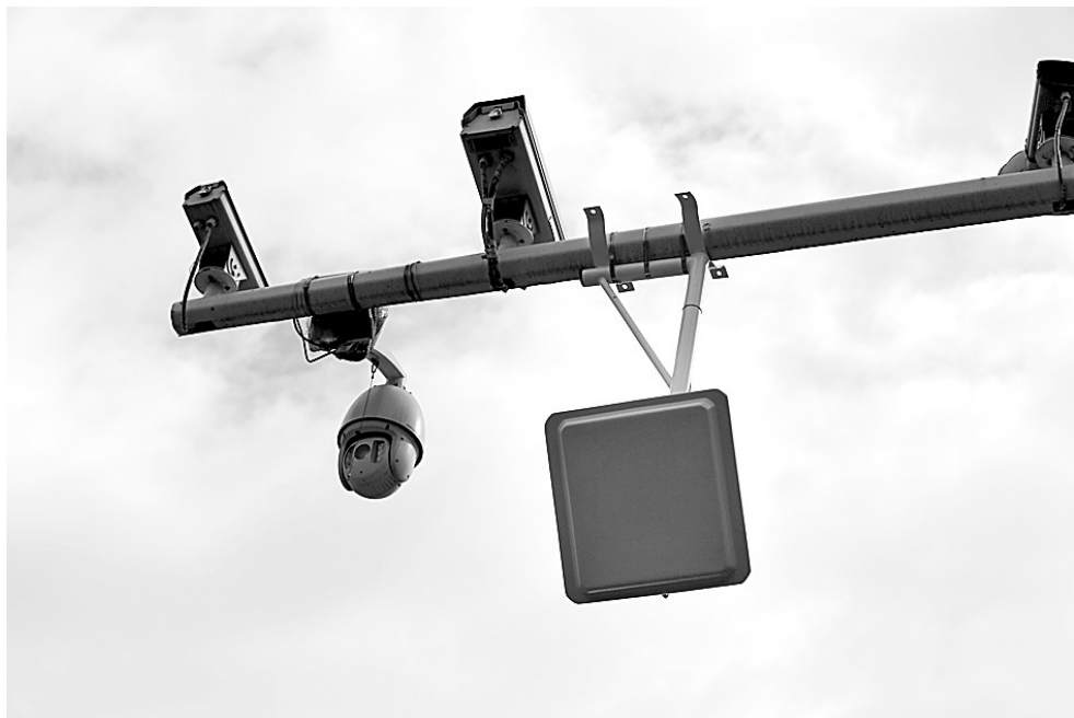
市区主要交通路口已安装了专门用来监测电动三轮四轮的设备 晚报首席记者 魏文慧 摄
