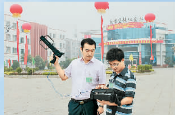
利用移动监测设备查找高考考试中的作弊信号
